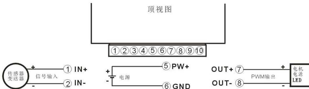
2, 模拟量输入, 一进两出, DIN12, 引脚定义:
