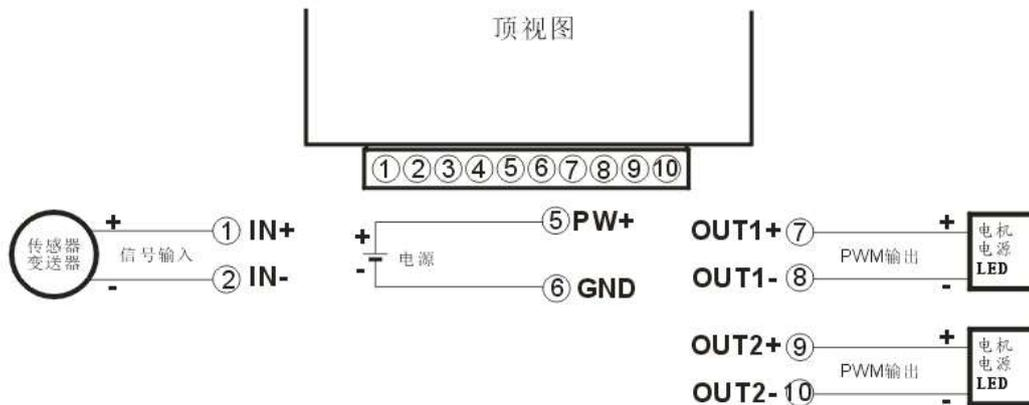
3, 模拟量输入, 两进两出, DIN22, 引脚定义:
