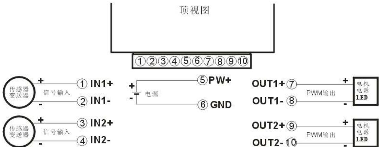
**4, RS485输入，一路输出，DIN11，引脚定义：**
