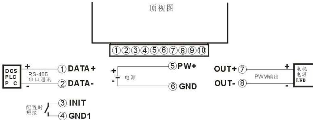
**5, RS485输入，两路输出，DIN12，引脚定义：**
