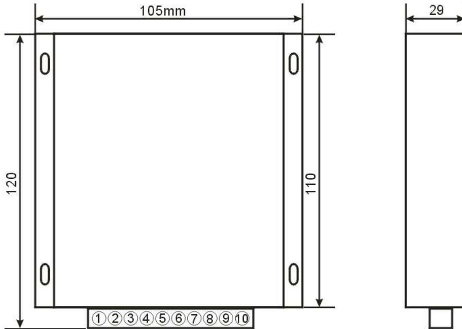
有 4 个螺丝孔, 可以装螺丝固定
