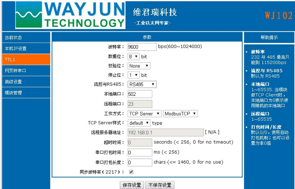
图 4 WJ102 设置成 MODBUS TCP 通讯协议后的参数
