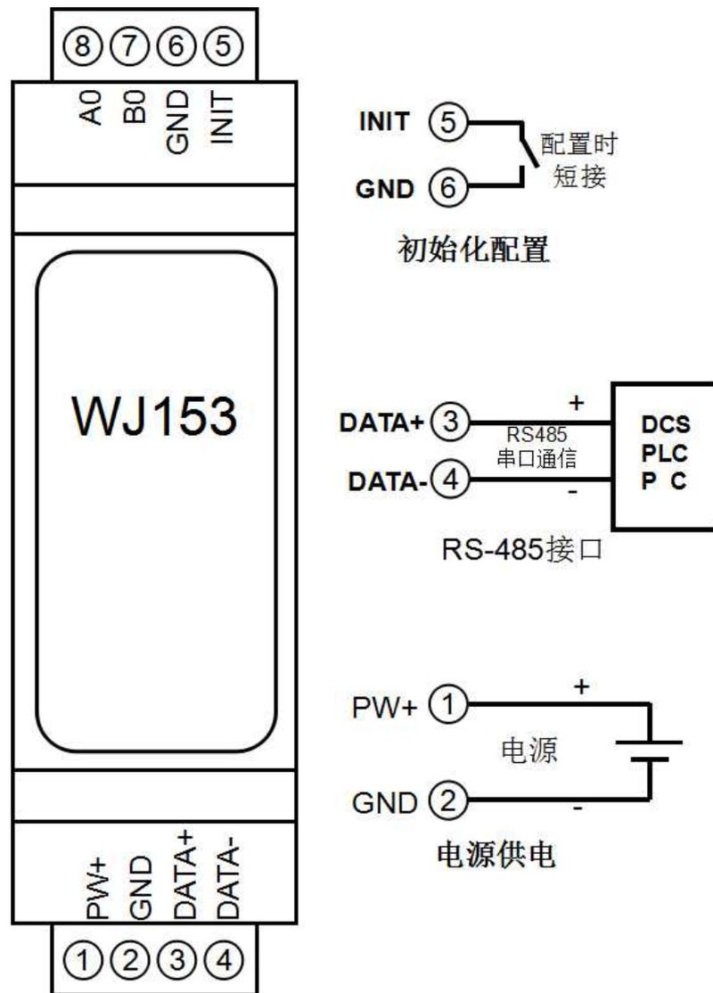
图3 WJ153 模块接线图
