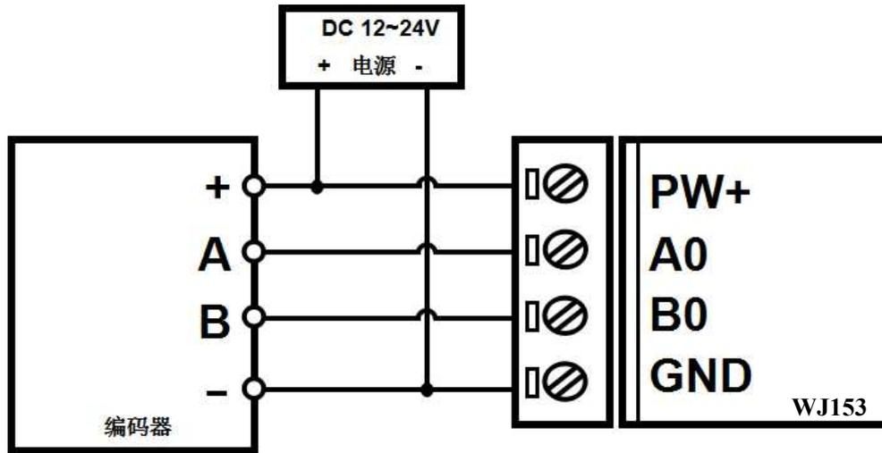
注：出厂默认是关闭上拉的，如果是 NPN 型编码器，需要打开内部上拉电阻，40082 寄存器设置为 1，或者发送字符命令 **S01Q1**。其他如带上拉电阻的 NPN 型编码器，PNP 型编码器，推挽式编码器等等可以直接使用。如果要关闭内部上拉电阻，40082 寄存器设置为 0，或者发送字符命令 **S01Q0**
