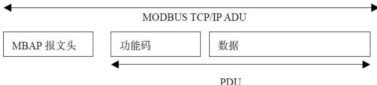
图 6: TCP/IP 上的 MODBUS 的请求/响应
