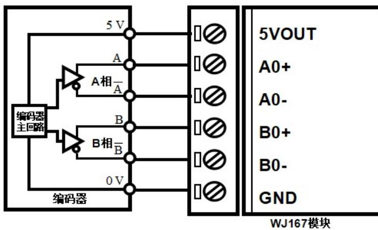
图 3 WJ167 模块接线图
