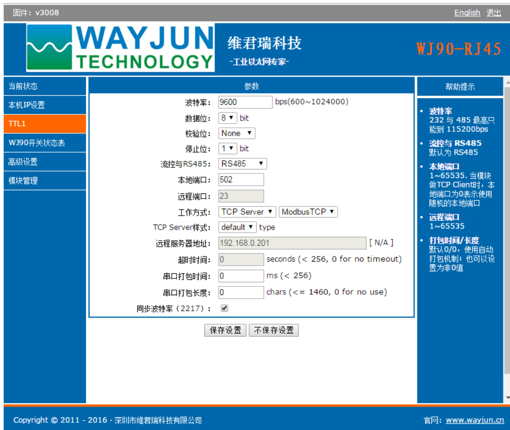
图 4 WJ90 设置成 MODBUS TCP 通讯协议后的参数
