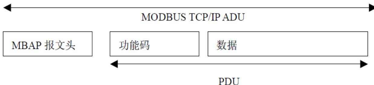
图 6: TCP/IP 上的 MODBUS 的请求/响应
